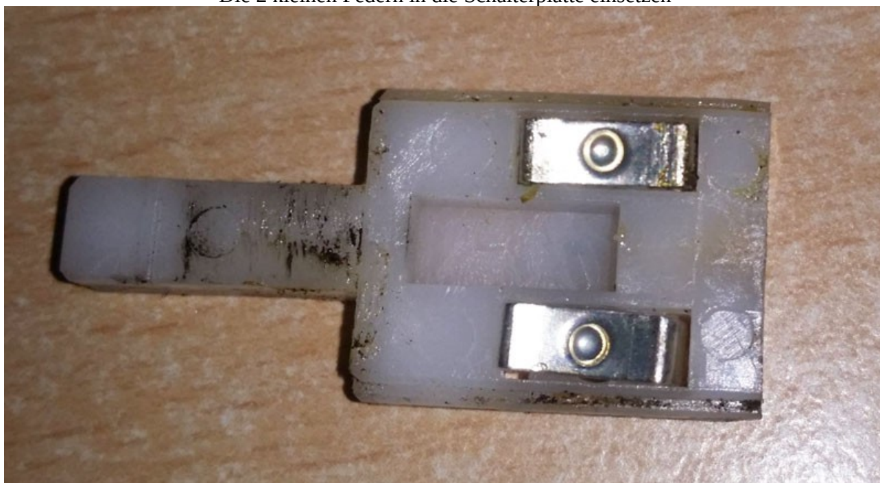
Die 2 Kontaktplatten auf die Federn setzen
