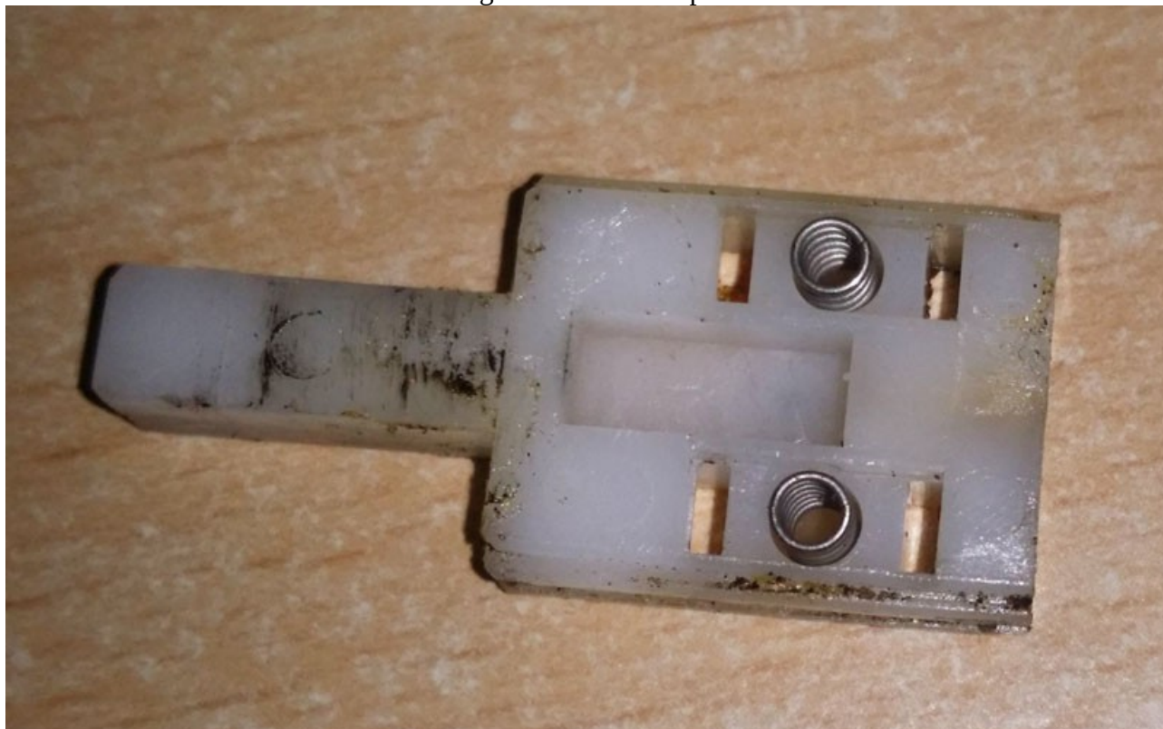
Die 2 kleinen Federn in die Schalterplatte einsetzen
